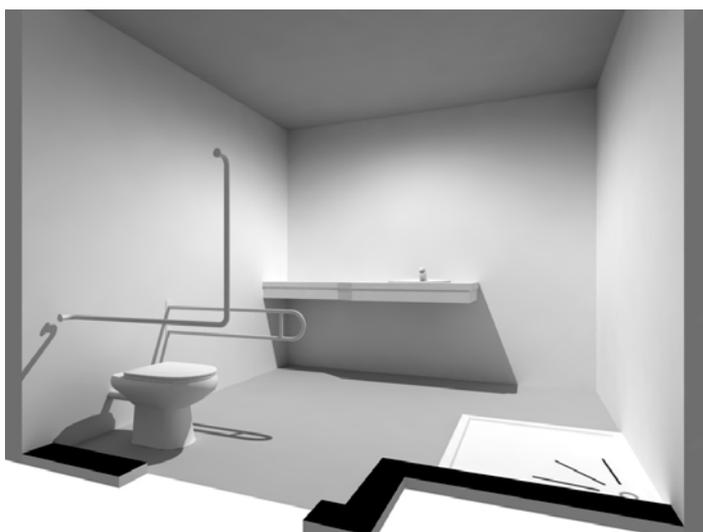
**Fig 6.41 – Possibilidade da adaptação da instalação sanitária às necessidades da PMC (ex., colocação de barras de apoio)**
