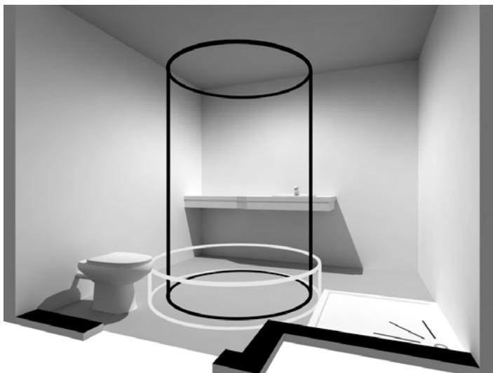
**Fig 6.39 – Nível 1: características de uma instalação sanitária por fogo (cilindro negro com  $\varnothing \geq 1,30$  m e  $h \geq 2,00$  m e cilindro branco com  $\varnothing \geq 1,50$  m e  $h \geq 0,30$  m)**
