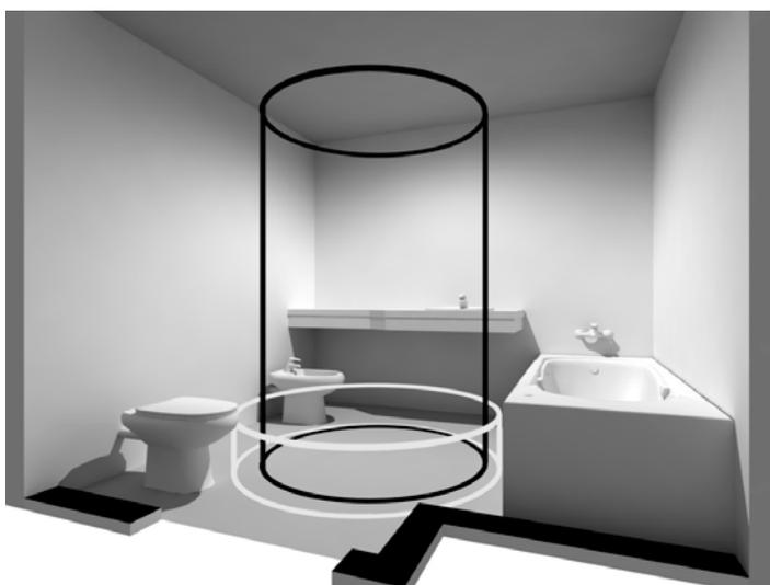
**Fig 6.40 – Nível 2: características de uma instalação sanitária por fogo (cilindro negro com  $\varnothing \geq 1,30$  m e  $h \geq 2,00$  m e cilindro branco com  $\varnothing \geq 1,50$  m e  $h \geq 0,30$  m)**
