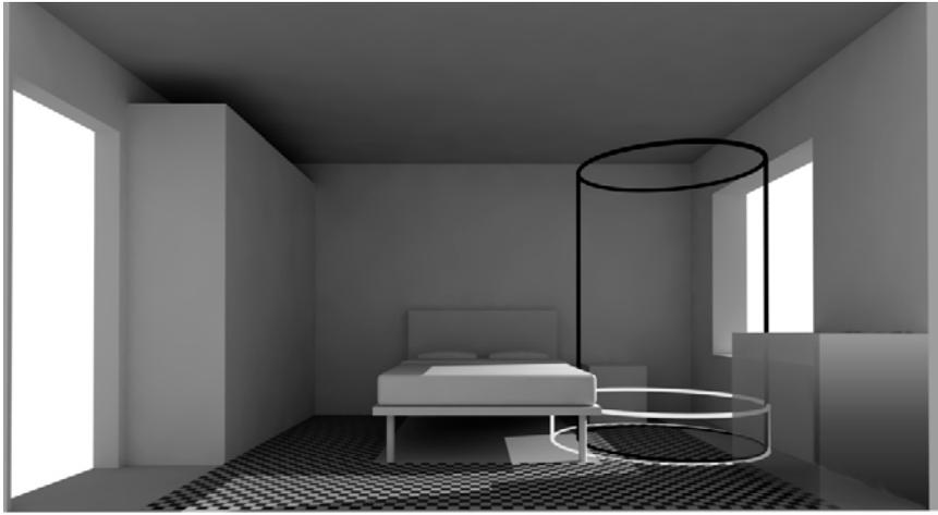
**Fig 6.36 – Características dos quartos acessíveis: cilindro negro com  $\varnothing \geq 1,30$  m e  $h \geq 2,00$  m; cilindro branco com  $\varnothing \geq 1,50$  m e  $h \geq 0,30$  m; faixa livre (xadrez) com 0,90m de largura**
